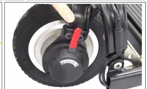
12 Vérifiez que le frein magnétique est en position VERROUILLÉE pour engager le moteur.
